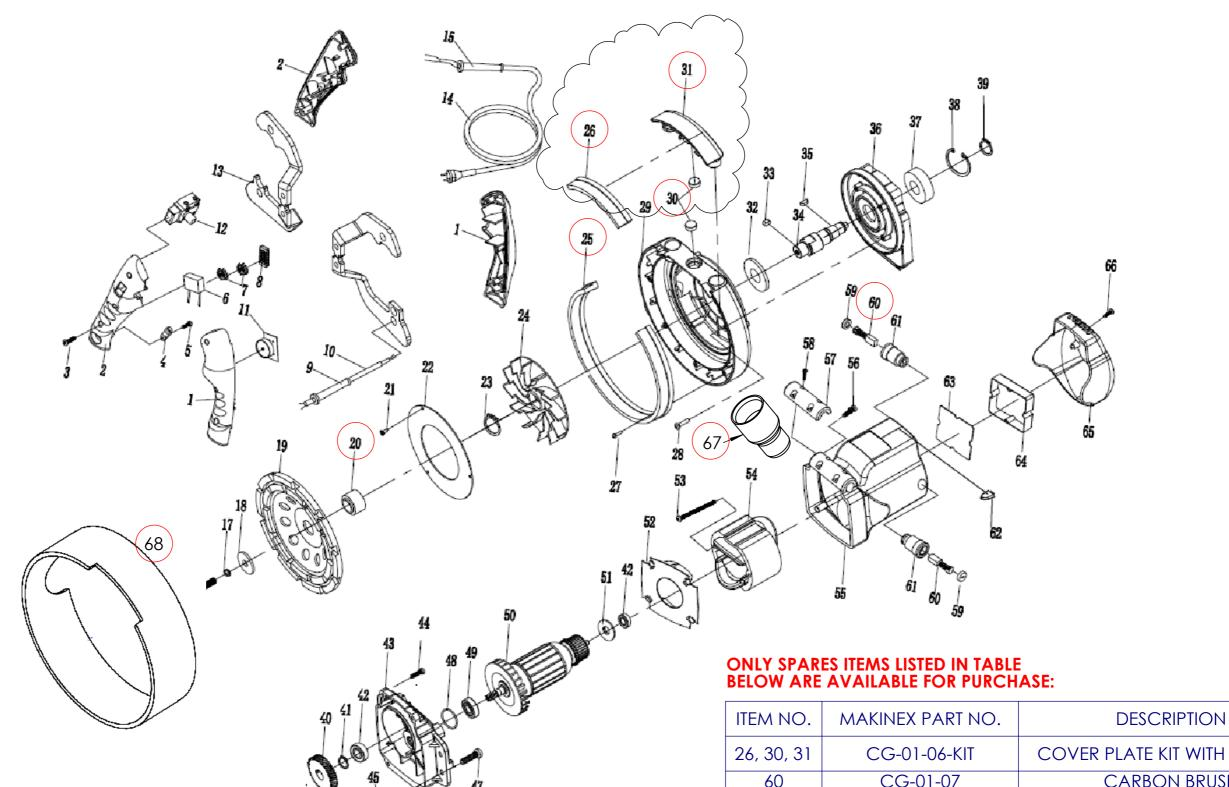
**COVER PLATE KIT WITH MAGNET** 60 CG-01-07 **CARBON BRUSH** MAKINEX VAC ADAPTER M38-F42 CG-01-03 67 CG-01-08 25 **BRUSH FOR DUST COVER** CG-03-01-04 68 **DUST GUARD** CG-01-09 **KEYWAY BLOCK SET** 20
